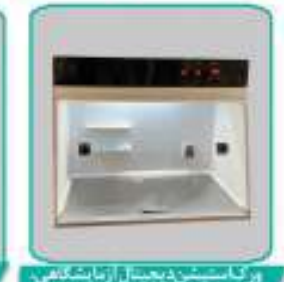
ورک استیشن دیجیتال آزمایشگاهی، با فضای اختصاصی سمپلر، پرز داخلی و سیستم روشنایی
