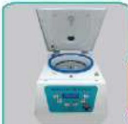
سانتریفیوژ میکروهماوکروت با دور قابل تنظیم تا 12000 RPM
